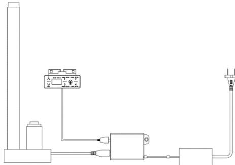
Verbinden Sie die Bestandteile wie in der Abbildung gezeigt. Achten Sie darauf, dass die Verbindungen fest eingesteckt sind. Schließen Sie nun das Stromkabel an, das Display sollte „61.0“ für ein paar Sekunden einblenden. Das bedeutet, dass das Tischgestell erfolgreich verkabelt wurde.
